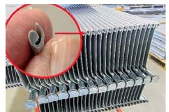
Zum Schutz vor Klappergeräuschen und Lackschäden wird in die Aussenkante der Aluminiumlamellen ein Kunststoffprofil eingewalzt.
