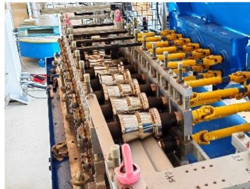
Das ursprünglich flache Aluminiumband kommt hier am vorderen Bildrand als halbfertige Lamelle aus den ersten Gerüsten der polierten Rollen des Walzwerks hervor.
