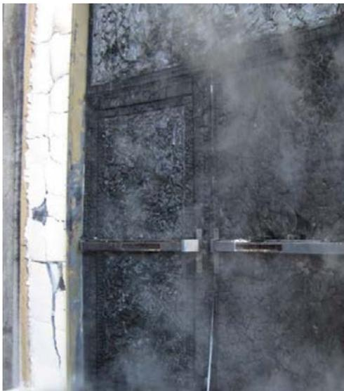
Die Brandprüfung des Türsystems - in diesem Fall eine Holztür mit «Fireblock»-Spezialdichtungen - erfolgt durch Beflammung bei 900 °C.
