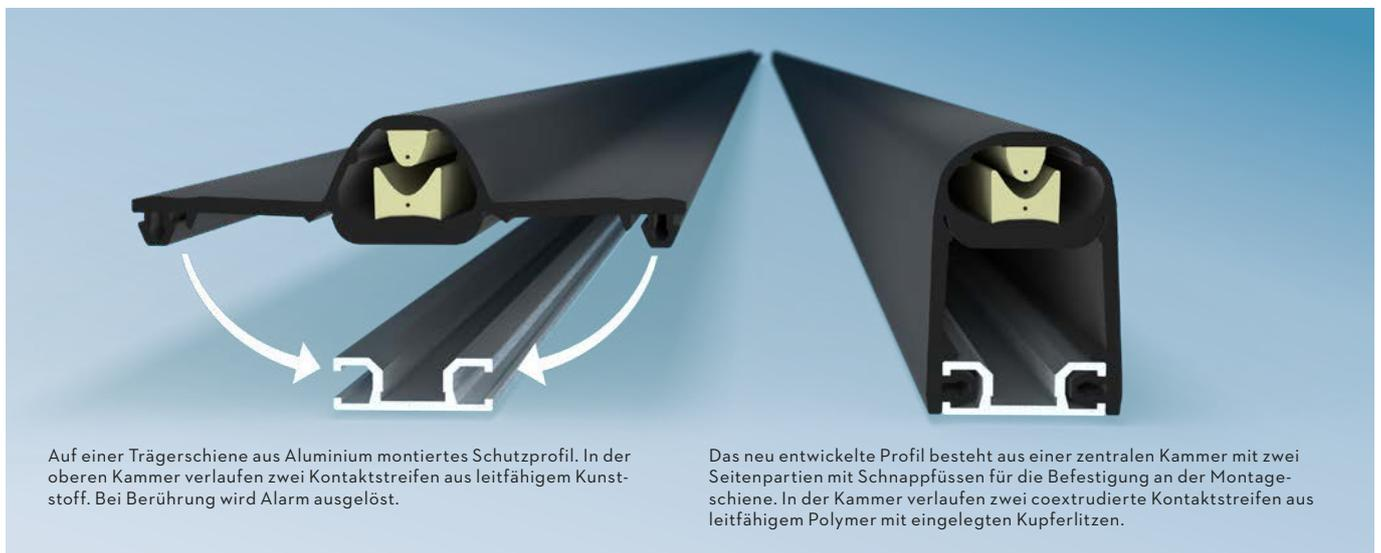
Auf einer Trägerschiene aus Aluminium montiertes Schutzprofil. In der oberen Kammer verlaufen zwei Kontaktstreifen aus leitfähigem Kunststoff. Bei Berührung wird Alarm ausgelöst.
